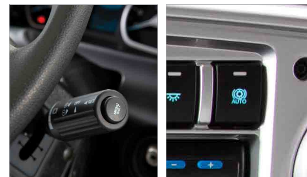
Motorfék és Intarder működtető kar: A kiegészítő fékek manuálisan aktiválhatóak, de engedélyezheti, hogy a jármű automatikusan állítsa be azokat.
