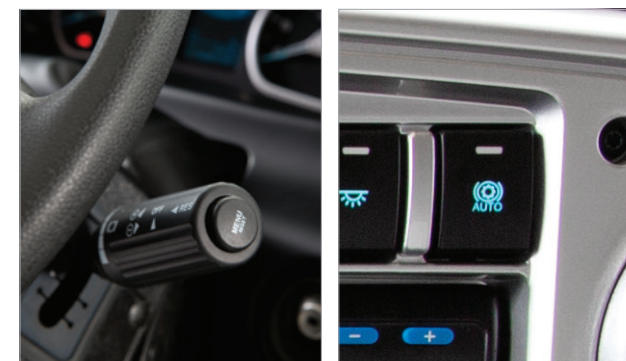
Motorfék- és Intarderváltó kar: A kiegészítő fékeket aktiválhatja manuálisan, vagy a járműre bízhatja azok automatikus vezérlését.
